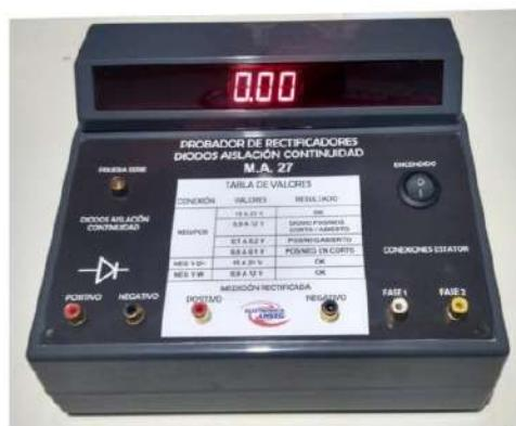
**ENCENDIDO:**Tecla para encender el display y todas las funciones del M.A.27.
